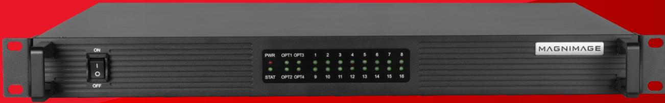
OPT16是针对LED显示屏开发的光电转换器，支持4路10G光纤，16路千兆网口输出，主要用于视频处理设备与LED显示屏距离较远的使用场景。
